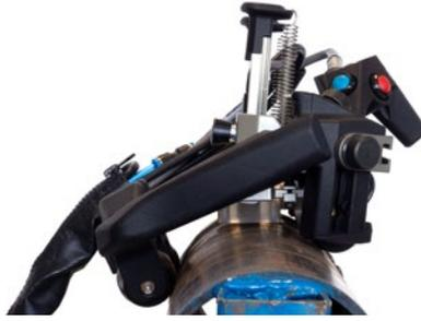
放置在周向焊缝上的AxSEAM扫查器, 装有2个探头, 管道的外壁直径为114毫米。
