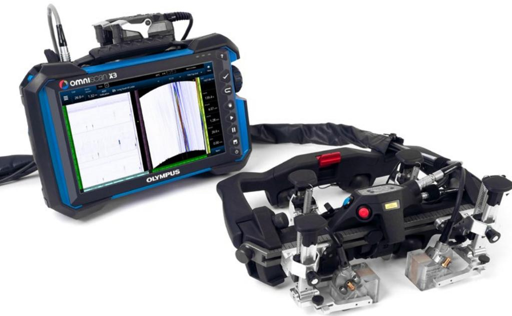
OmniScan X3探伤仪的多技术功能, 可使操作人员首先对焊接纵缝进行快速PA/TOFD筛查, 然后在无需更换探头的情况下, 再使用全聚焦方式 (TFM) 对关注区域进行更有针对性的检测。
