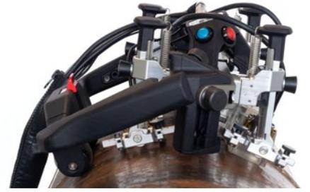
放置在周向焊缝上的AxSEAM扫查器, 装有4个探头, 管道的外壁直径为324毫米。
